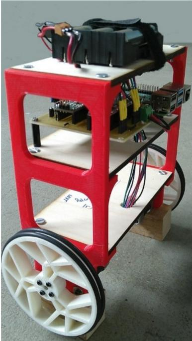
Le système mécatronique proposé pour ce projet est un *balancing robot* : c'est un robot instable à deux roues motorisées, équipé d'une carte Arduino et d'une carte RPI 4, avec la batterie placée tout en haut ; il ne demande qu'à tomber vers l'avant ou vers l'arrière.
